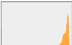
Falls das Bild **überbelichtet** ist, befinden sich die Histogramm-Werte am rechten Rand der Grafik, das heisst, dass die Aufnahme grösstenteils hohe DN ausweist. Verkürzen Sie die Belichtungszeit oder schliessen Sie die Blende.
