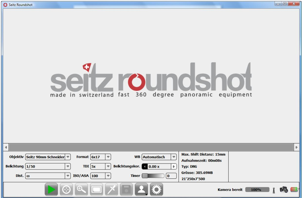
Wählen Sie die gewünschten Aufnahme-Parameter: Objektiv, Belichtungszeit, Fokussier-Distanz, Bildwinkel, TDI Stufen und ISO/ASA.
