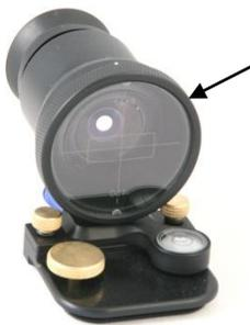
Drehen Sie im Gegenuhrzeigersinn, um den Sucher zu öffnen (im Uhrzeigersinn, um den Sucher zu schliessen)
