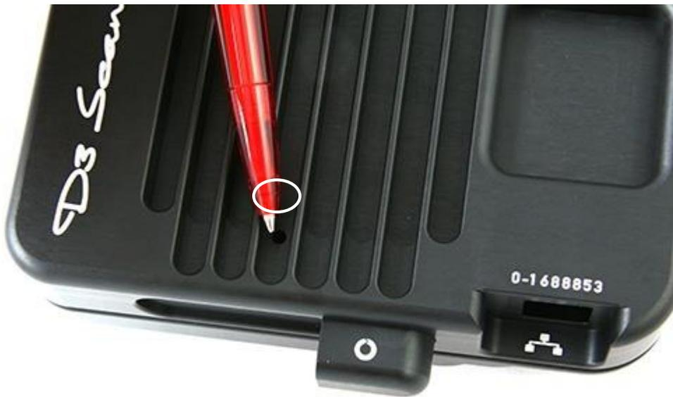
Drücken Sie mit einem Kugelschreiber oder einem Schraubenzieher in die Reset-Öffnung auf der Rückseite des Seitz D3 digitalen Scan-Rückteils. Halten Sie einige Sekunden gedrückt.
