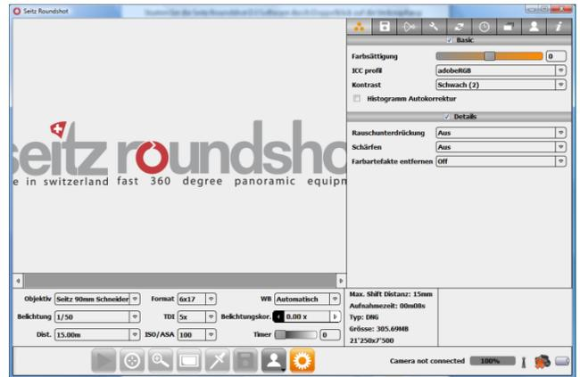
Das **“Aufnahme-Menü”** wird dazu verwendet, die Kamera zu bedienen, die Bildaufnahme zu steuern, die Bildvorschau anzuzeigen und die Bilder zu speichern. Es erlaubt zudem den Zugang zu den meist verwendeten Bildaufnahme-Parameter wie zum Beispiel Objektiv (Favoritenliste), Belichtungszeiten, Weissabgleich oder ISO/ASA. Die Kamera-Status-Informationen (Verbindung oder Batteriezustand) sowie Bilddaten (Histogramm oder Grösse) werden im Informationsfeld angezeigt.
